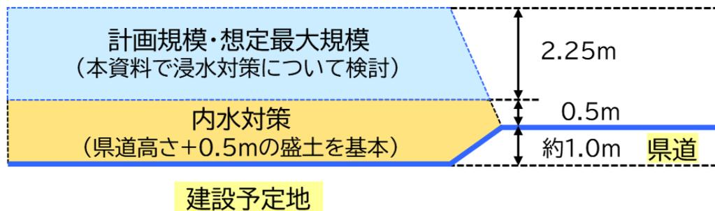
図 1 浸水対策に関する検討イメージ図(第8回建設検討委員会資料2より再掲)
